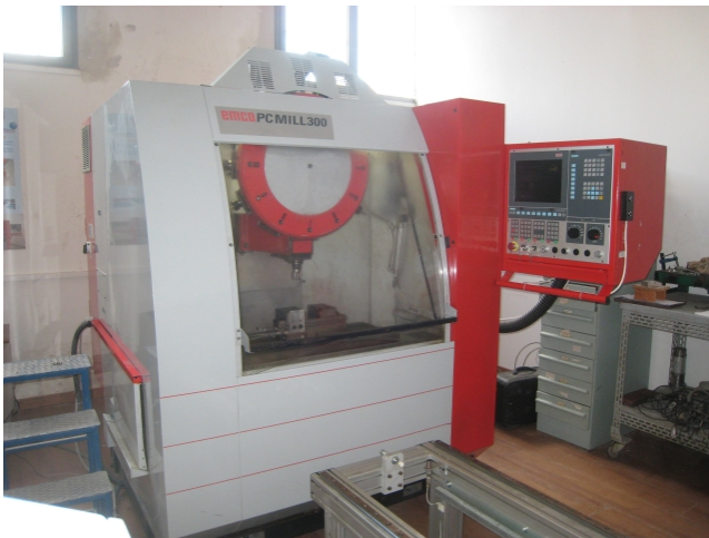
Abb. 1: Fernangesteuerte CNC Maschine in Palermo für Tests von Schweißverfahren
